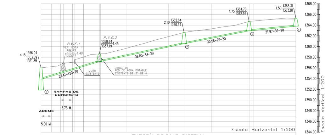
**TUBERÍA DE P.V.C. SISTEMA MÉTRICO SERIE 20 DE 20 CMS DE Ø**
