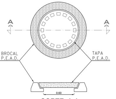
**DETALLE DE BROCAL Y TAPA PARA TRÁFICO PESADO DE POLIETILENO DE ALTA RESISTENCIA A CARGA HASTA 30 000 KG, CUYO PESO DEL CONJUNTO DE HASTA 50 KG (QUE CUMPLA CON LA NORMA POR LA SCT Y CONAGUA)**
