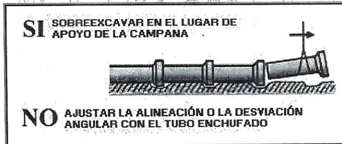
Fig. 6.- Detalle de la campana en tuberías.
