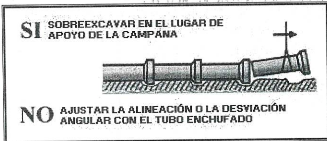
Fig. 11.- Detalle de la campana en tuberías.
