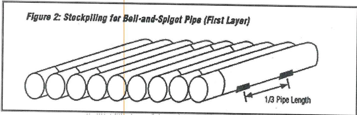
*Fig. 3.- Detalle de almacenamiento de la tubería.*
