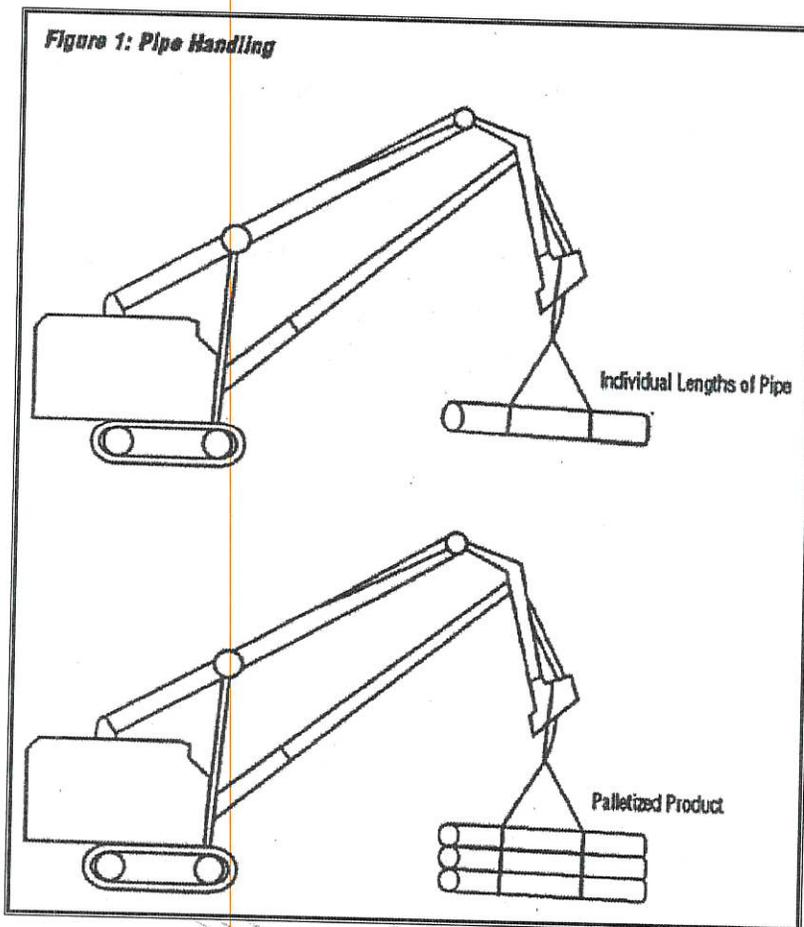
*Fig. 2.- Descarga de tubería.*
