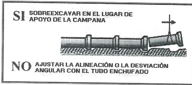
Fig. 11.- Detalle de la campana en tuberías.
