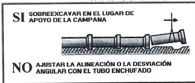
Fig. 11.- Detalle de la campana en tuberías.
