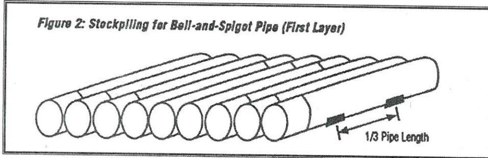
*Fig. 9.- Detalle de almacenamiento de la tubería.*
