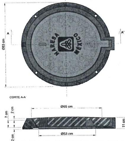
El Brocal está compuesto de halo expandido para descansar en el lomo de la corona del pozo de inspección (campana), y reforzado en cuatro puntos por medio de nervaduras exteriores.
