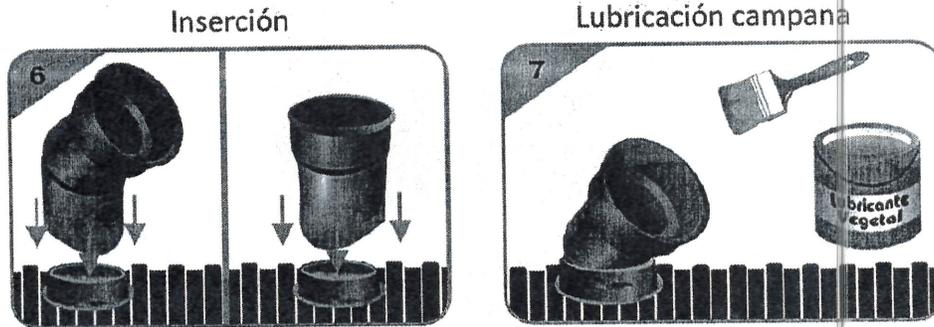
Finalmente se lubricará sólo lo suficiente la punta del tubo que será colocada en la campana, dejando una pendiente mínima del 1% para poder ejecutar la descarga correctamente.
