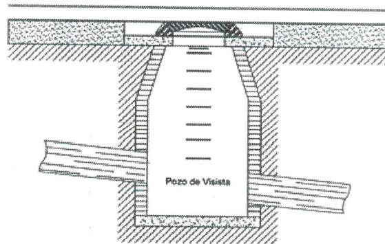
Colocar tapa y brocal, previamente ajustada a una plancha de concreto con un diámetro interior igual o semejante al diámetro del brocal pozo de visista para evitar cualquier tipo de ruptura.
