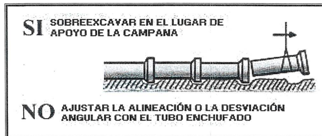
Fig. 4.- Detalle de la campana en tuberías.
