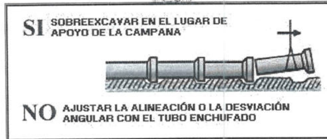
Fig. 5.- Detalle de la campana en tuberías.
