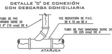
**DESCARGA DOMICILIARIA TIPO PARA TUBERÍA DE P.V.C. SERIE 20 DE 20 CMS DE Ø**
